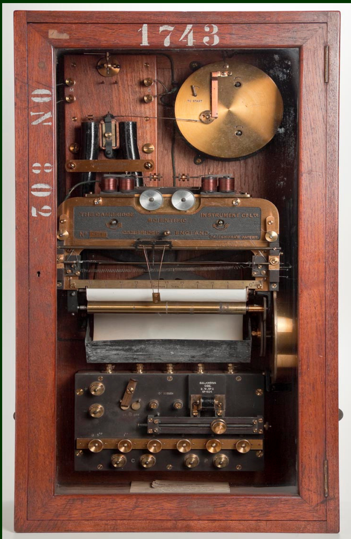
Termógrafo registrador elétrico (acervo MAST). Foto: Jaime Acioli, 2010.
